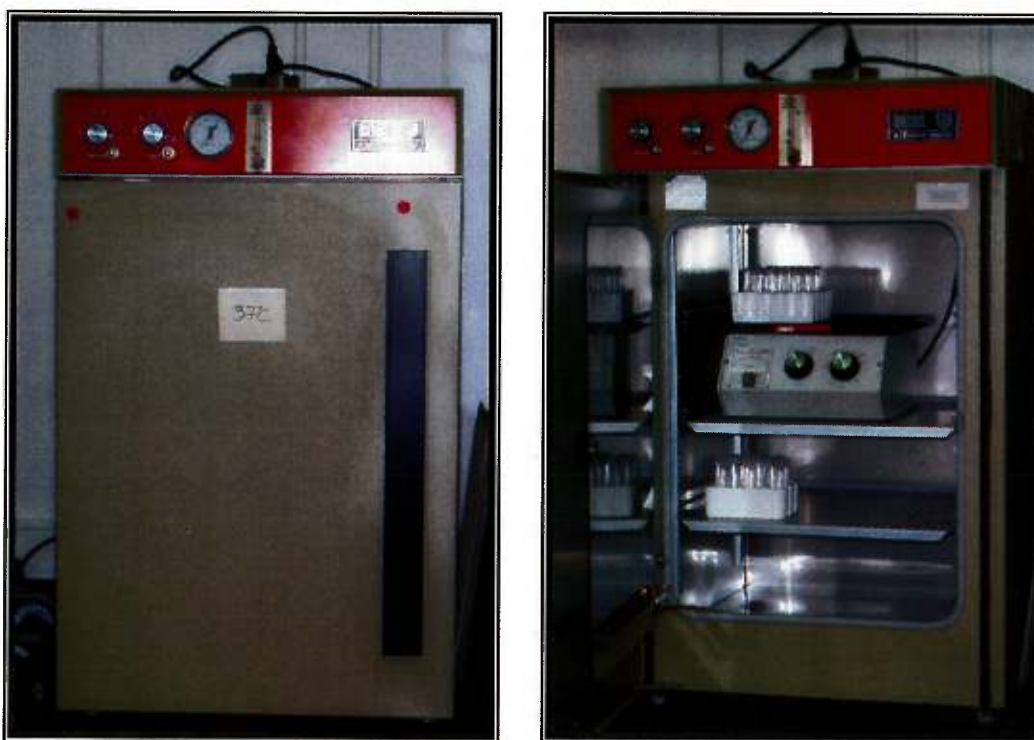
Figure 9.2 : Incubateur à air sec maintenu à 37°C (montrant l'agitateur et les flacons sur l'image de droite)
