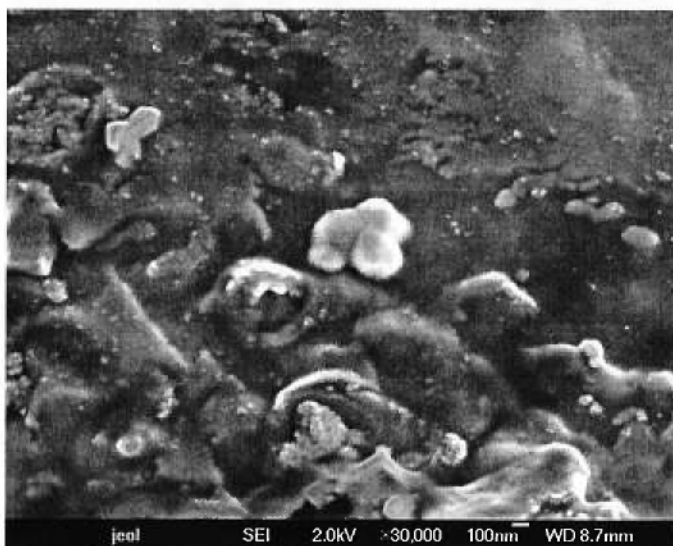
Figure 9.27 : Images par SEM du E-N-NiTi Neo-Sentalloy (expérimental U. de Mtl) avant immersion. (Fil de section ronde de diamètre 0,016")
