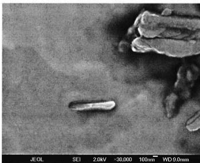
Figure 9.24 : Images par SEM du NiTi Neo-Sentalloy IONGUARD avant immersion. (Fil de section rectangulaire 0,016" x 0,022")
