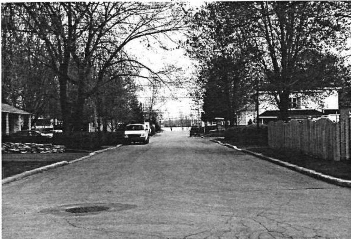
Figure 40: La rue Sainte Marguerite. Nous voyons l'espace resserré du tissu urbain du Vieux-Vaudreuil à cause de l'étroitesse de la partie carrossable (11,5 mètres) et du recul du bâti (6 mètres). L'emprise du domaine public est elle aussi de 11,5 mètres.
