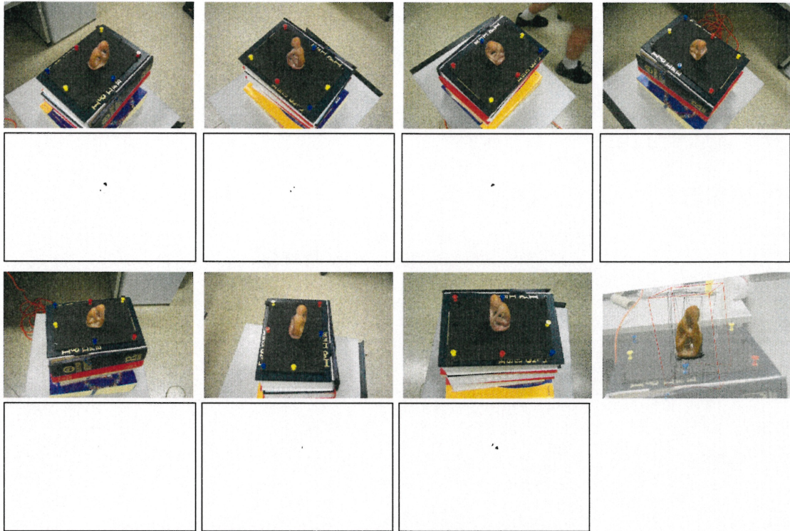
FIG. 8.13 – Les sept dernières images de la scène de la statuette avec leur masque de rejet correspondant (affiché en couleurs inversées) et le volume de reconstruction en bas à droite.
