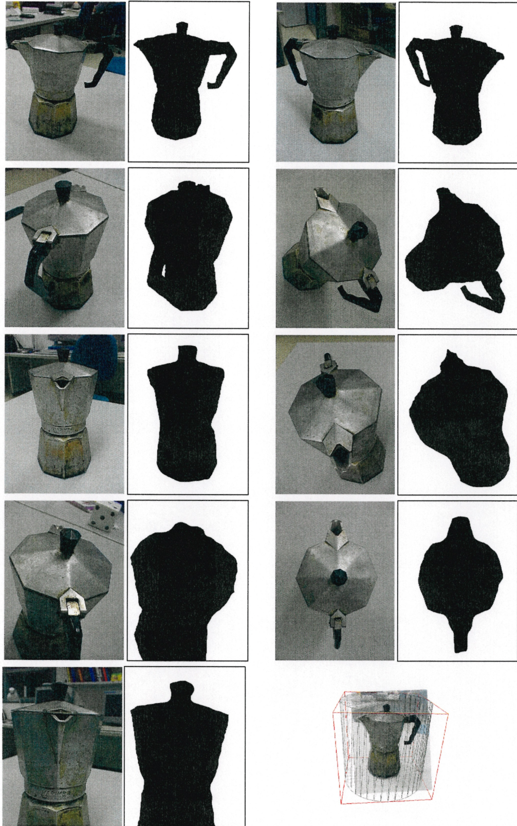
FIG. 8.8 – Les neuf images de la scène de la cafetière avec leurs masques de rejet correspondants et le volume de reconstruction en bas à droite. Résolution des images : 480 \times 640 pixels.
