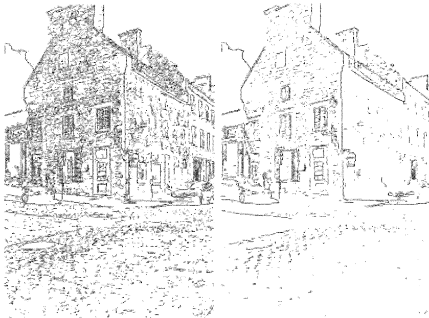
FIG. 7.19 – Exemple de détection supervisée de contours à l'aide de l'algorithme de Canny. De haut en bas : image originale ; contours détectés avec \tau_l = 18.5 et \tau_h = 37 ; contours détectés avec \tau_l = 40 et \tau_h = 80 .
