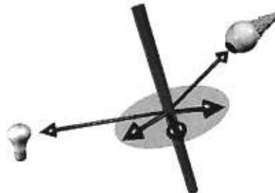
FIG. A.3 – Pour l'illumination spéculaire de Phong, les directions de la lumière et de l'oeil sont projetées sur le plan des normales. La normale sélectionnée est dans la direction moyenne des deux directions projetées.
