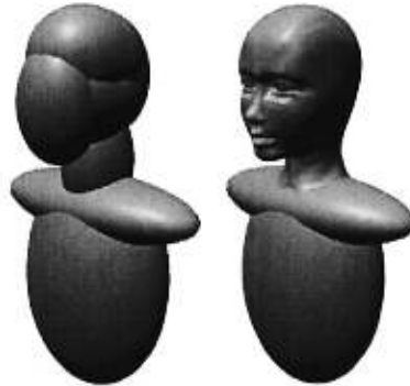
FIG. 4.9 – Le personnage (à droite) est approximé par des ellipsoïdes (à gauche) pour faciliter la détection de collisions. La partie inférieure du modèle est identique pour le modèle et son approximation simplement parce qu'elle a été ajoutée au modèle original pour l'expérience. Au total, dix ellipsoïdes sont utilisés dans cet exemple.
