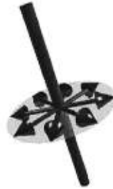
FIG. A.1 – Toutes les normales d'un cheveu dans un pixel forment un disque dont la normale est dans la direction du cheveu.
