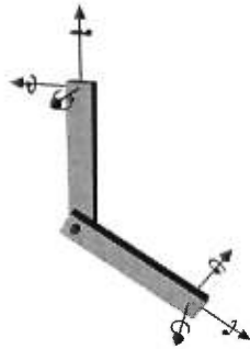
FIG. 2.1 – En coordonnées maximales, chacun des deux solides du coude a six degrés de liberté.
