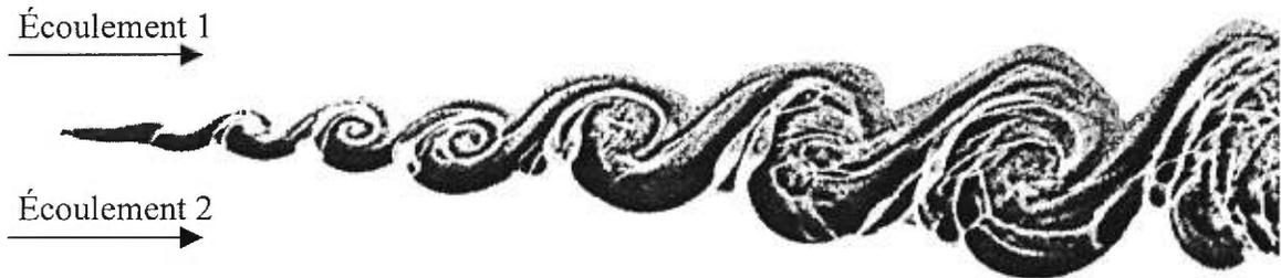
**Figure 2.6** Plan de mélange entre deux écoulements gazeux donnant naissance à des structures turbulentes qui se développent dans l'espace et se répètent dans le temps (Roshko et Brown, 1974).
