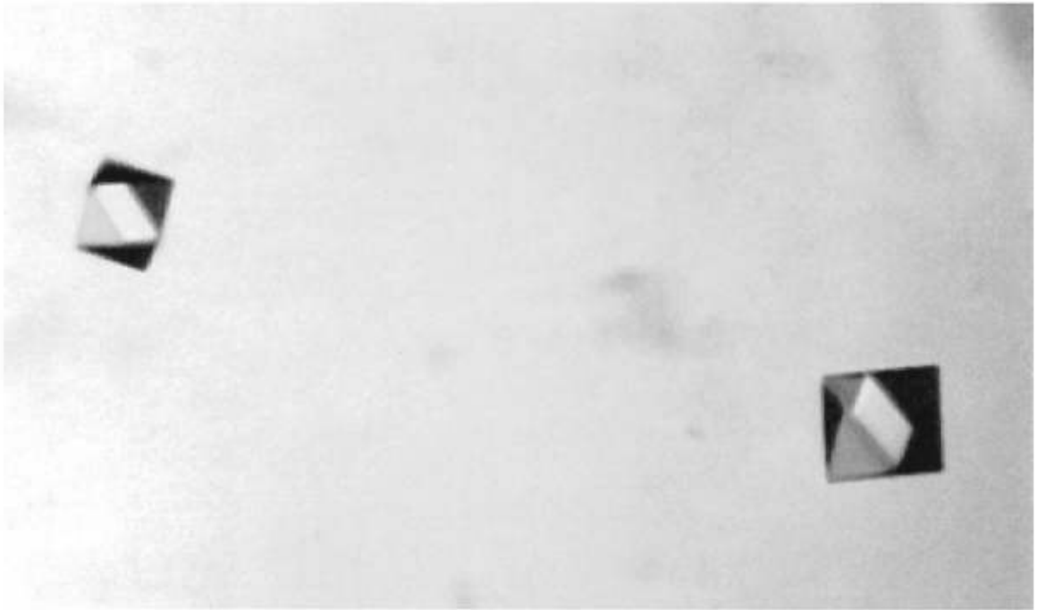
Figure 5. Photographie de deux cristaux de FBP aldolase de Taq sélénométhionée Ces cristaux mesurant 250 \mu\text{m} entre les pointes des deux pyramides et 160 \mu\text{m} de côté à la base de la pyramide, ont été obtenus par diffusion de vapeur dans une goutte suspendue équilibrée contre 0,6 M de sulfate d'ammonium et 200 mM d'acide citrique pH 4.
