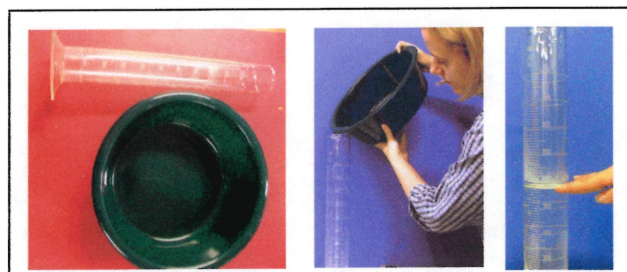
Figure 3.25 : Mesure du débord d'eau
