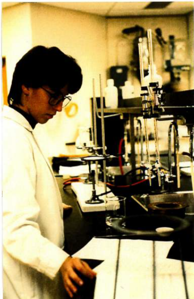
Figure 6 Détermination de la teneur en calcium des bouillons (titrimétrie) (Laboratoire du Pavillon de Nutrition, Université de Montréal) (1990-10-23)
