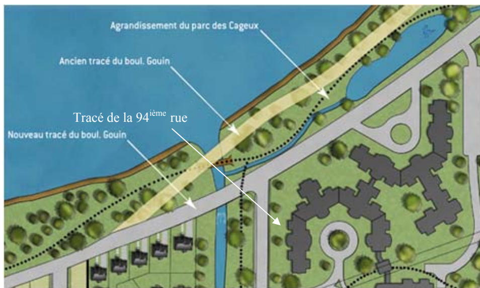
Figure 28 : Déplacement du Boulevard Gouin Est
