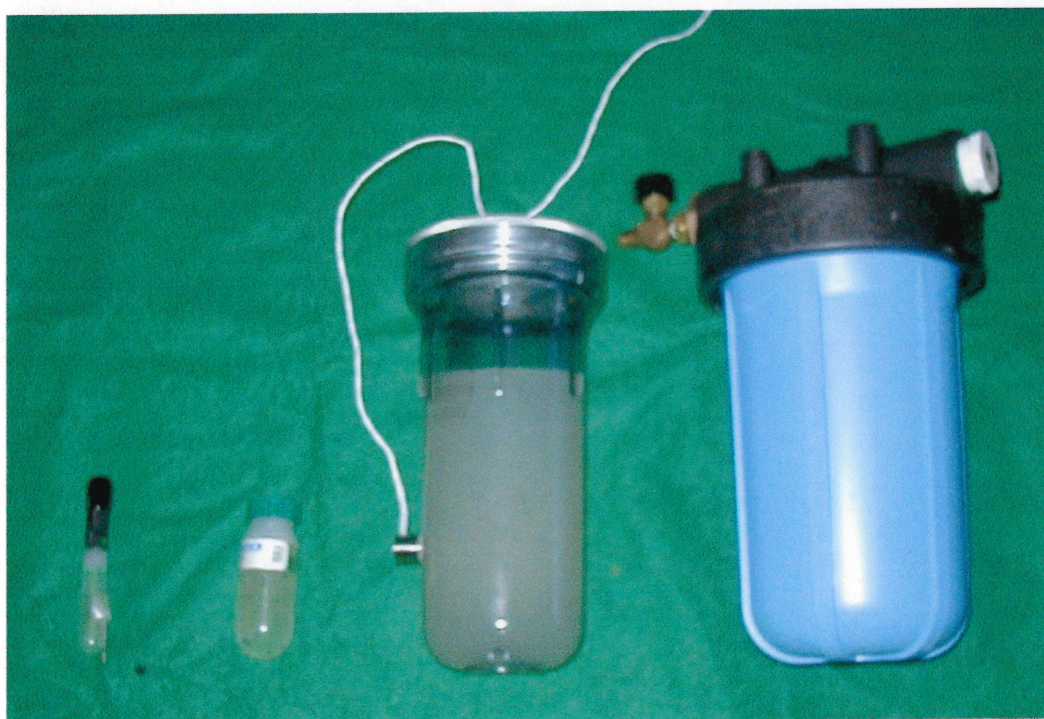
Figure 5: Évolution des détecteurs PICASSO. De gauche à droite, le modèle 8 ml, le modèle 60 ml, le modèle 1.5 l, et l'étape suivante prévue, un module de 3 l.
