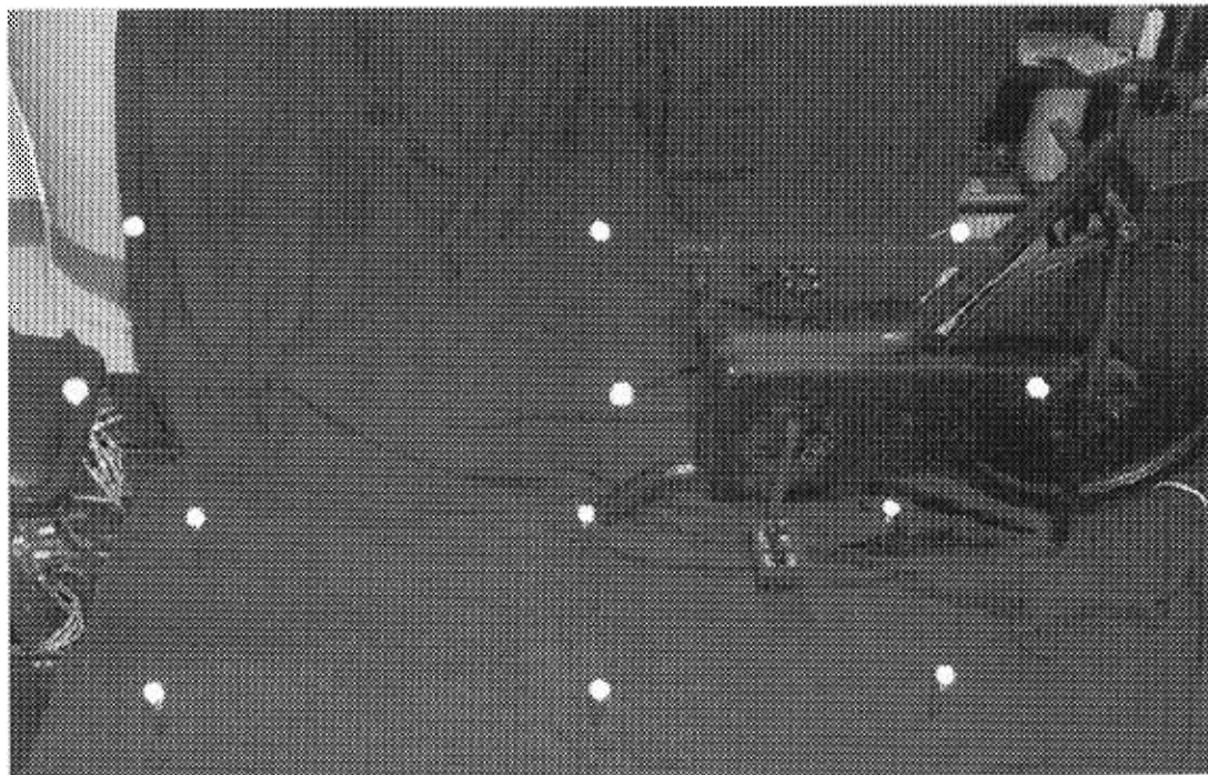
Figure 3.6 Volume de calibrage à 12 réflecteurs utilisé pour l'analyse cinématique.
