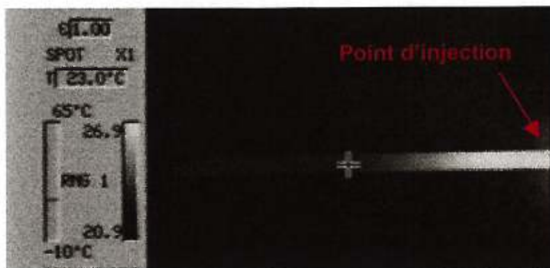
Figure 5.2 : Capture infrarouge montrant le gradient thermique à l'intérieur d'une colonne remplie lors d'une injection de haut volume. (Réalisée à Rimouski, Laboratoire du Dr. Jean-Pierre Gagné).
