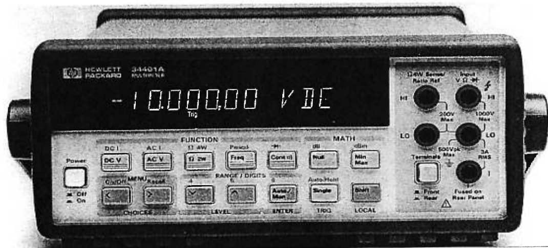
Figure 8_ Panneau avant réel du HP34401 20
