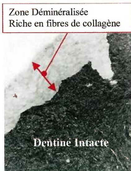
**Figure I-8:** Image par microscopie TEM (Transmission Electron Microscopy) de la dentine déminéralisée.
