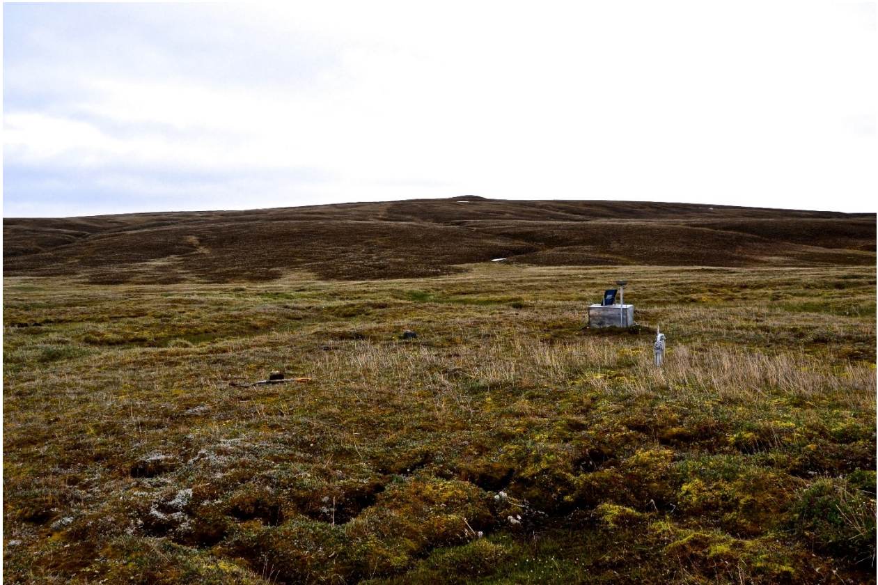
Figure 14. – Polygones à coins de glace à centre déprimé humide (ADAPT, 2019). Un câble à thermistance d'une profondeur de 3m est installé au centre du polygone. En guise d'échelle, la boîte de bois servant à protéger l'enregistreur de données du câble à thermistance fait environ 60cm de largeur. Des dépôts glaciaires formant des collines sont observable en arrière-plan et constituent des milieux mésiques. La photographie a été prise le 31 juillet 2013 aux coordonnées suivantes : 73°8'30,4'' N ; 79°58'1,2'' O.
