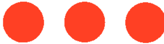
Figure 2. Signe spécial international pour les ouvrages et installations contenant des forces dangereuses.
