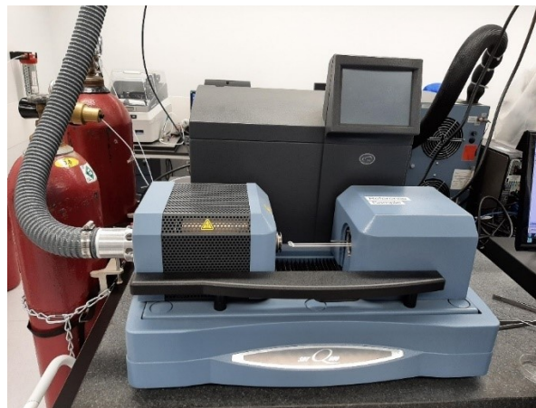
Figure 2.3 Instrument pour analyse thermogravimétrique de type SDT Q600.
