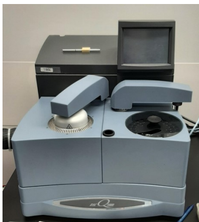
Figure 2.1 Instrument d'analyse calorimétrique différentielle à balayage de type Q1000.
