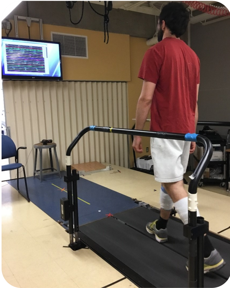
Figure 12: Installation en laboratoire de la marche sur tapis roulant instrumenté.
