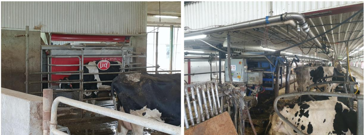
Figure 1. – Modèle de robot stationnaire (gauche) et mobile (droite)
