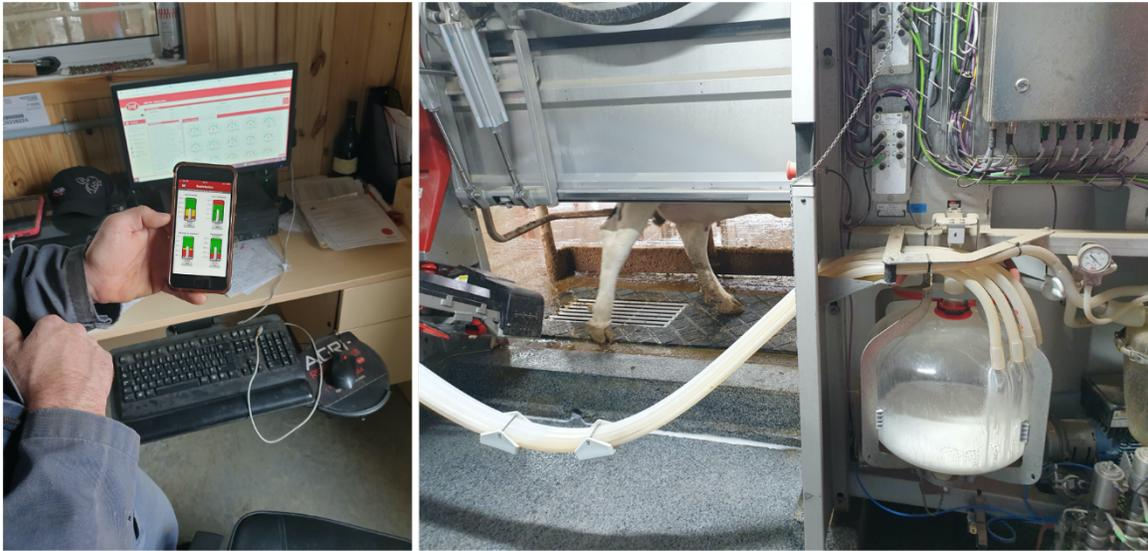
Figure 3. – Application mobile avec les informations de traite par quartier (gauche) et intérieur du robot de traite (droite)
