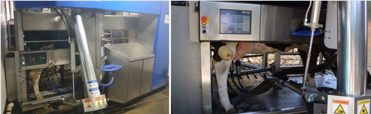
Figure 2. – Bras articulé et gobelets trayeurs du robot de traite
