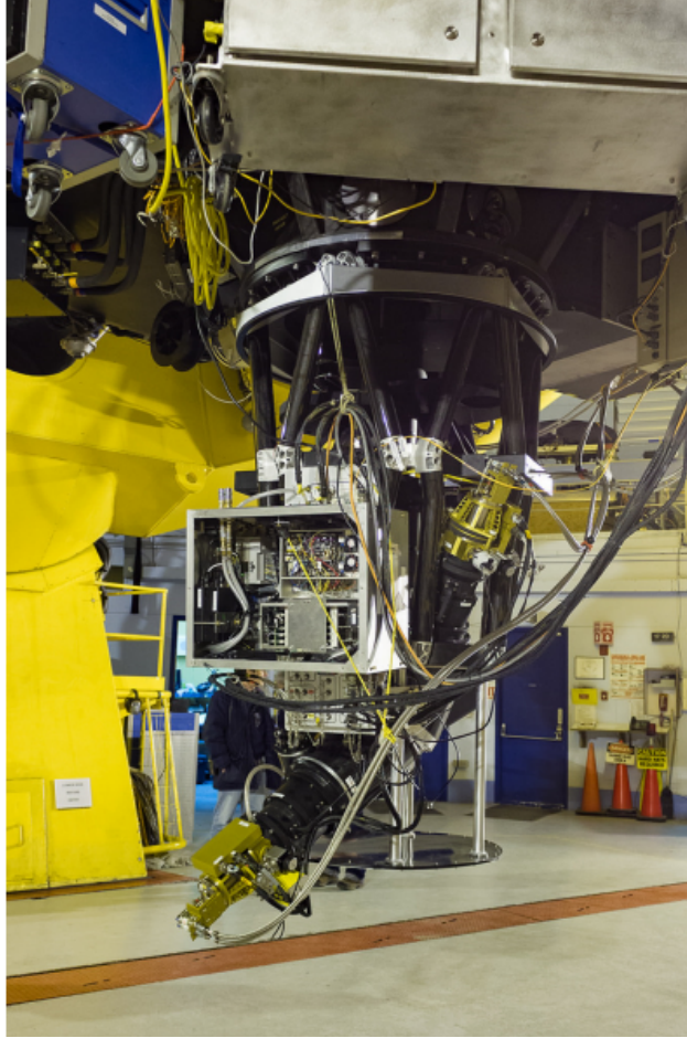
Figure 2.1 – Image de SITELLE : on aperçoit les deux détecteurs (dorées) aux extrémités. Image tirée de Drissen et al. (2019).
