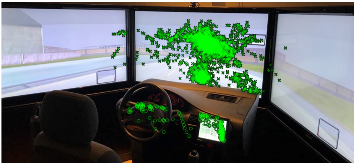
Figure 3 : Schéma des fixations et réallocations entre la route, le tableau de bord ainsi que l'outil de navigation lors de la conduite automobile.
