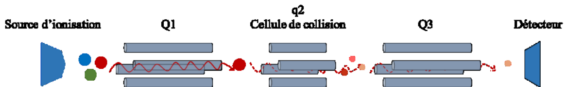
Figure 2.9 Schéma de fonctionnement d'un analyseur de type triple quadripôle
