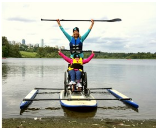
Figure 1 : Exemple d'une planche à pagaie adaptée pour un personne utilisant un fauteuil roulant manuel ( http://www.accessrevolution.com/ ).
