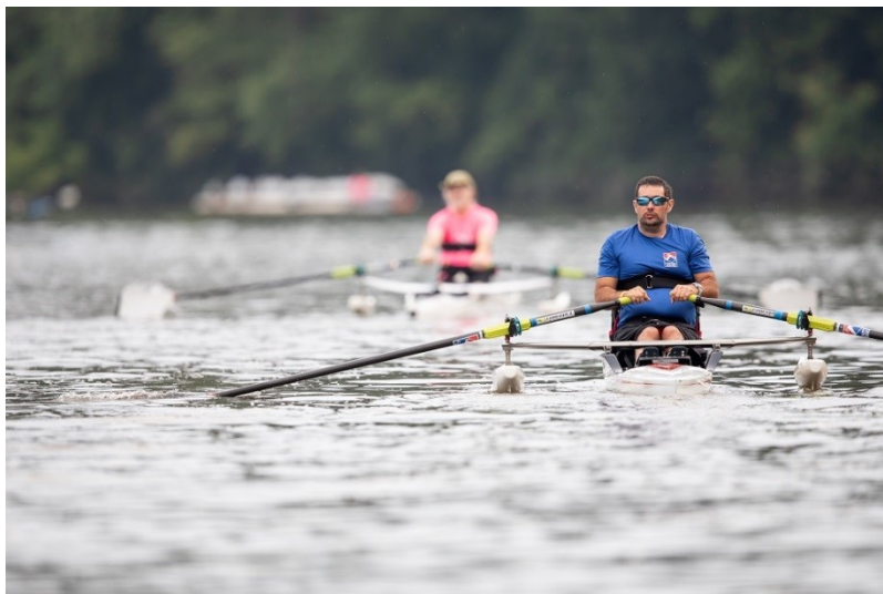
Figure 5. Exemple d'un aviron présentant des stabilisateurs sur les côtés et dont l'utilisateur porte une sangle au niveau abdominal
