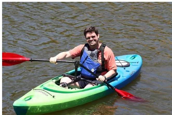
Figure 2. Exemple d'un kayak muni d'un système de pagaie sur pivot
