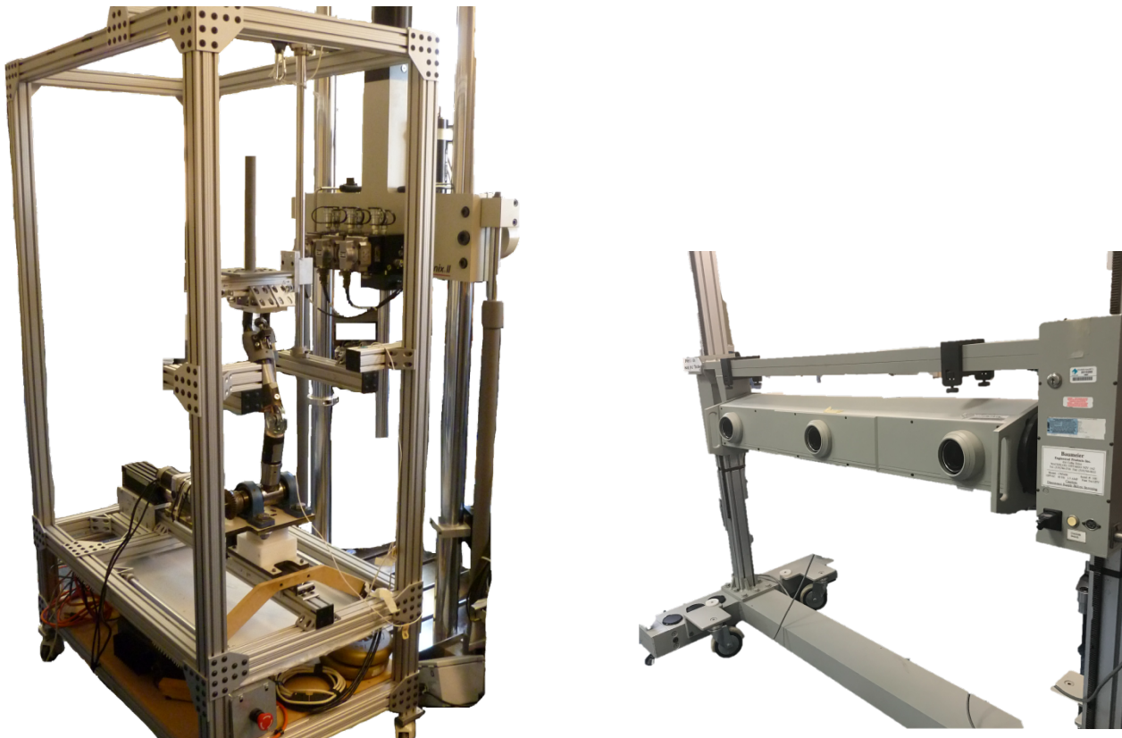
Figure 20. Le banc d'essai (gauche) et le système de caméras Optotrak (droite) utilisés pour l'acquisition de données de cinématique 3D.
