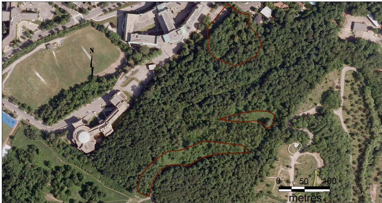
Figure 8. Localisation des zones de remblai observées lors de l'inspection visuelle.
