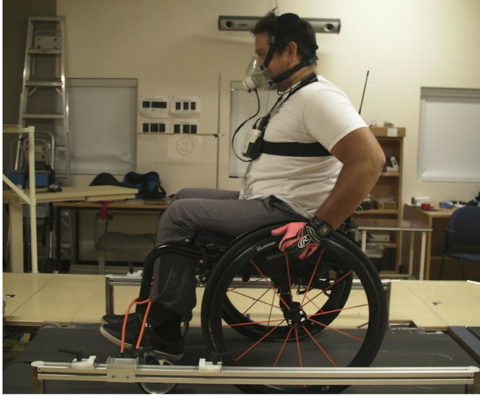
Figure 6 : Illustration de la propulsion du fauteuil roulant manuel sur tapis roulant motorisé lors de l'évaluation des aptitudes cardiorespiratoires
