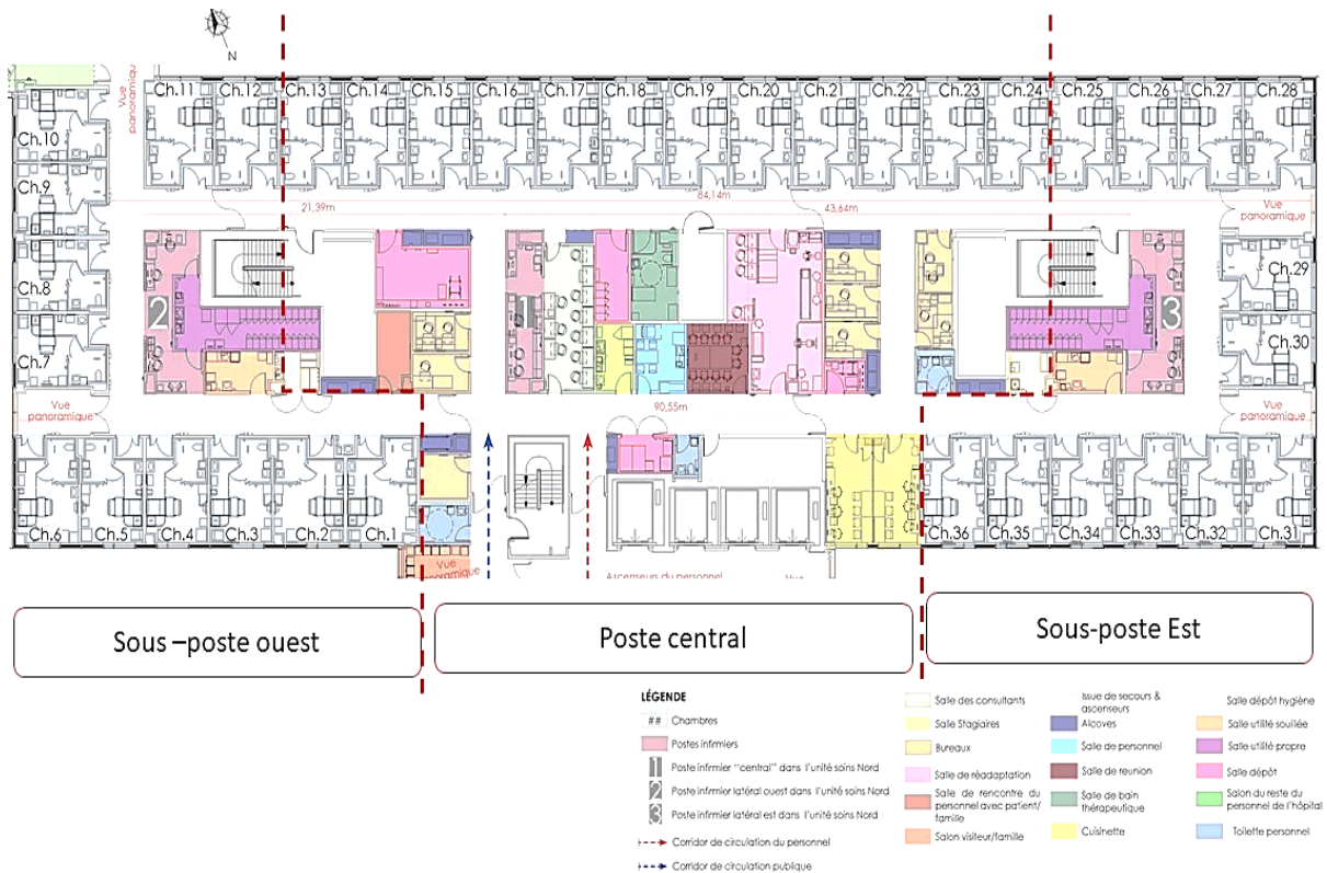
Figure 54. Répartitions des chambres de patients par poste de travail dans une unité de soins nord.
