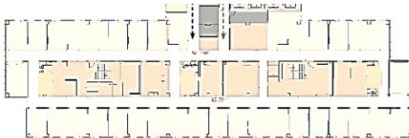
Figure 8. Exemple d'une organisation spatiale linéaire à double corridor Schéma tiré du plan d'une unité de soins du nouveau CHUM (©CHUM, 2017) où à chaque étage deux unités de soins sont reliées par une bande de circulation horizontale et verticale et espaces de service.
