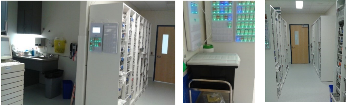
Figure 49. Salles d'utilité propre et système à double casiers Vues sur deux salles d'utilité propre dans des unités de soins sud (à gauche) et nord (à droite) au nouveau CHUM, avec le tableau de commande de matériel par puces. © Z. Hammouni, 7 août 2018
