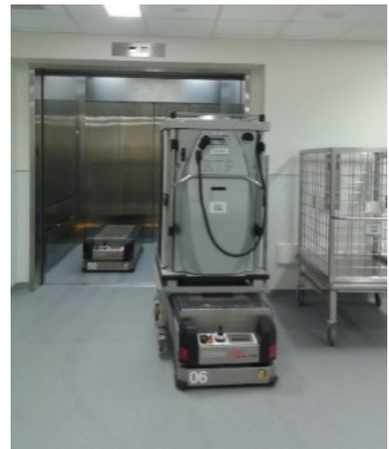
Figure 15. Véhicules autoguidés dans une station aux étages. Vu sur les véhicules autoguidés transportant les charriots des repas arrivant dans un local de service aux étages dans le pavillon (D). ©Z. Hammouni. 30 août 2018.
