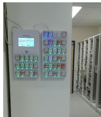
Figure 18. Système d'approvisionnement à puces dans la salle utilité propre-unité de soins. ©Z. Hammouni, 7 août 2018.
