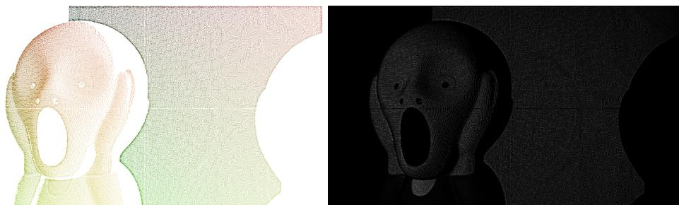
Figure 3.3. Inverser une carte de correspondance caméra  $\rightarrow$  projecteur ne fonctionne pas dans toutes les situations, puisque la correspondance n'est pas forcément  $1 \leftrightarrow 1$ , ce qui peut laisser des trous dans la carte inversée
