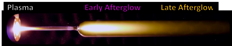
Figure 20 : Image de la post-décharge en flux d'azote. On y distingue ses quatre principales régions.
