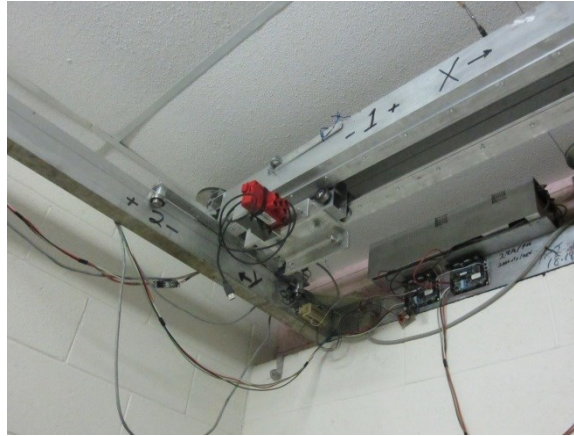
Figure 8.3 – Dispositif sur rails portant la caméra Micasense RedEdge.
