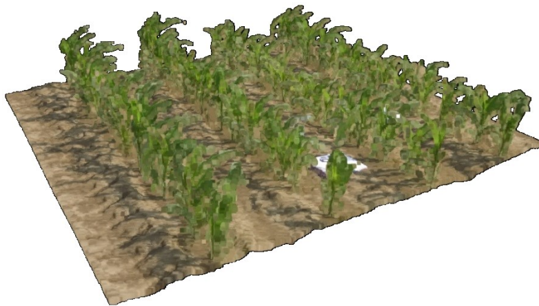
Figure 8.1 – Vue 3D d'une portion d'un champ de maïs, à la ferme de L'Acadie, été 2016. L'image a été produite à l'aide du logiciel Pix4Dmapper Pro à partir d'images droniques acquises avec le Phantom 3 Professional.
