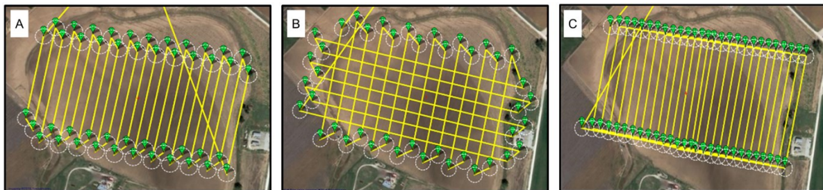
Figure 3.2 – Trois différents plans de vol : (A) lignes de vol parallèles; (B) lignes en quadrillage; (C) lignes de vol en boîte-mobile. Les lignes jaunes représentent les lignes de vol et les points verts les points de passage le long de la ligne de vol pour la navigation GNSS (Shi et al. , 2016).
