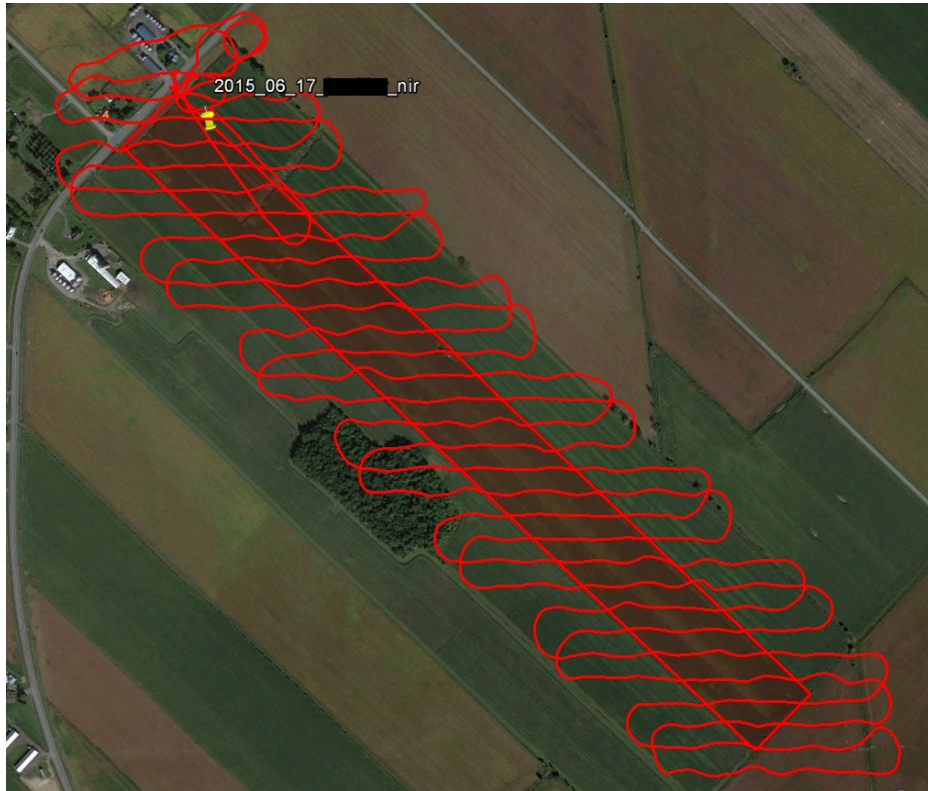
Figure 7.2 – Trajectoire de vol en boîte mobile au-dessus du champ 2, le 17 juin 2015. La zone d'intérêt à survoler est identifiée par le rectangle rouge, dont les dimensions sont environ 1390 m x 125 m (source : capture-écran du logiciel eMotion 2).
