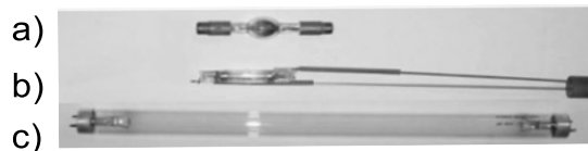
Figure 1.7 Lampe au mercure utilisée pour la photochimie : a) à haute pression, b) à moyenne pression, c) à basse pression. Reproduit avec la permission de la réf. 7a. Copyright 2009 Wiley-VCH.
