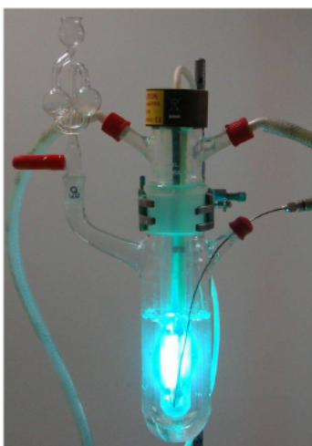
Figure 1.8 Lampe au mercure à pression moyenne dans un puits d'immersion. Reproduit avec la permission de la réf. 7a. Copyright 2009 Wiley-VCH.
