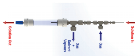
Figure 3.7 Représentation graphique du système d'évaporateur développé par le laboratoire du Pr Ley
