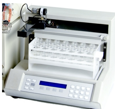
Figure 3.5 Photographie d'un collecteur de fractions automatisé de la marque Vapurtech®
