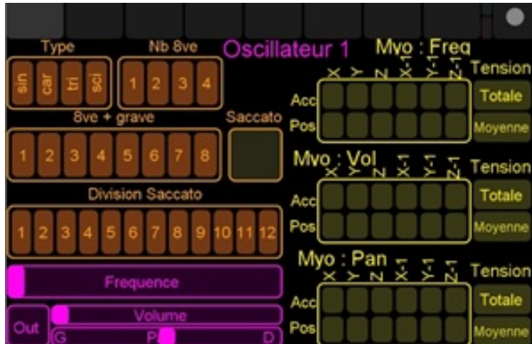
Figure 2.2. Interface finale du dispositif numérique pédagogique développé conjointement avec le pianiste Alex Soucy. En jaune les paramètres du bracelet Myo, en rose les paramètres variables de l’oscillateur, en orange les paramètres fixes de l’oscillateur.
