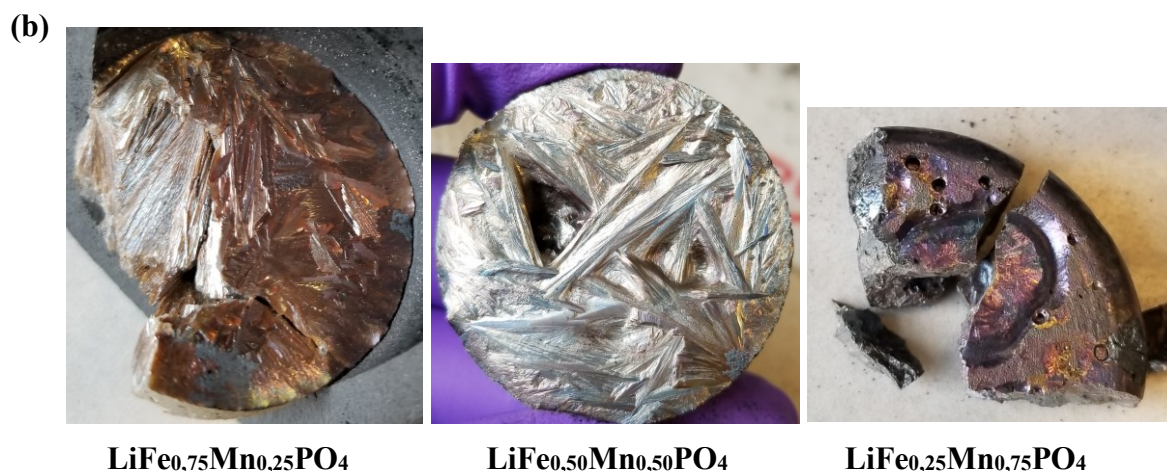
Figure 30. Lingots de LFMP ( x= 0.25, 0.5, 0.75 ) synthétisés : a) à 1000 °C et b) à 1100 °C sous atmosphère réductrice.
