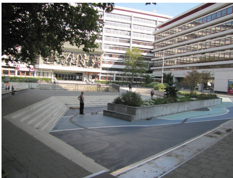
Figure 40. Bassin collecteur d'eau de pluie ( watersquare ) à Rotterdam, Pays-Bas, conçu par l'agence De Urbanisten. Source : Wikimedia Commons, 2017.
