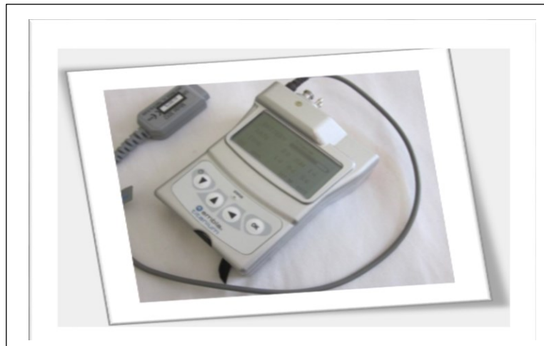
Figure 2.1 A : L'appareil Embla Titanium : C'est un appareil fiable et assez sensible pour le diagnostic de l'AOS [122], déjà utilisé dans plusieurs études, dont le projet pilote de l'étude. Il est constitué d'une série d'électrodes qui ont été placées sur la tête et le visage des participants (Tableau III)
