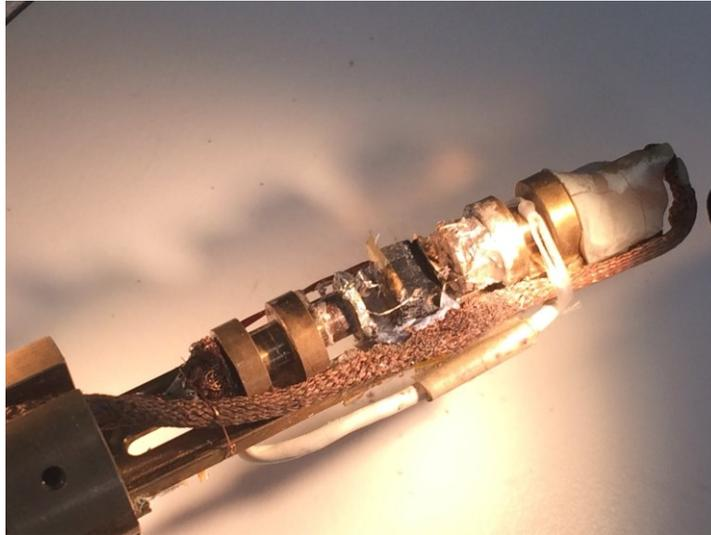
FIGURE 5.11 – Photo d'un échantillon de  $\text{Ce}_2\text{Zr}_2\text{O}_7$  monocristallin installé sur une sonde avant d'être inséré dans un réfrigérateur à dilution à HZDR. Les transducteurs collés de part et d'autre de l'échantillon avec de la colle cryogénique sont ensuite connectés à la sonde par des fils d'or avec de la pâte en argent afin d'obtenir une bonne conductivité électrique.
