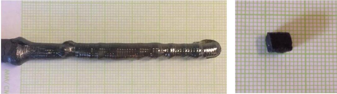
FIGURE 5.6 – Sur la photo de gauche, on a un échantillon de  $Ce_2Zr_2O_7$  obtenu par croissance par zone fondue dans le four optique en décembre 2017, pour les mesures en ultrasons et pour les mesures en chaleur spécifique. Sur la photo de droite, on a un échantillon taillé et poli pour les mesures en ultrasons. La surface plane est perpendiculaire au plan cristallin [111].
