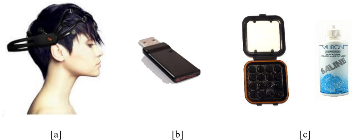
Figure 3.3 Dispositif matériel du pack Emotiv EPOC: [a] le casque, [b] le récepteur USB et [c] le kit d'hydratation des senseurs
