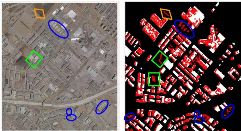
Figure 7.8 : Sources d'erreurs sur la détection des bâtiments
