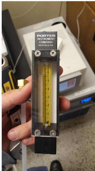
Figure 23. Premier débitmètre utilisé (*Porter instrument company*) pour de débit d'argon dans les entrées de gaz de l'adaptateur
