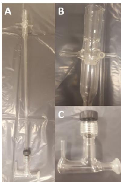
Figure 28. Premier adaptateur vertical comportant 5 entrées de gaz, un court tube (0,6 mm), un long tube extérieur (350 mm) introduit dans l'ICP-MS perpendiculairement. En A, l'adaptateur complet, en B, le haut de l'adaptateur et en C, le bas de l'adaptateur.
