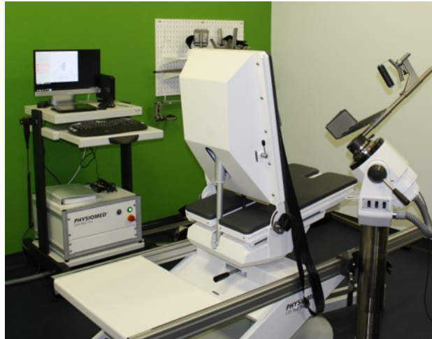
Figure 7: Exemple d'un dynamomètre isocinétique, le CONTREX ® MJ de la compagnie Physio-med.
