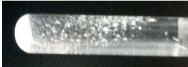
Figure III-4. Précipitation de PNL-N2.6 chauffé à 45° en présence de 10 mM de NaPh 4 B.
