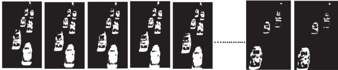
FIGURE 7.4 : Segmentation en mouvement d'une séquence vidéo par l'algorithme de mélange gaussien adaptatif [22] sur la séquence railway .
