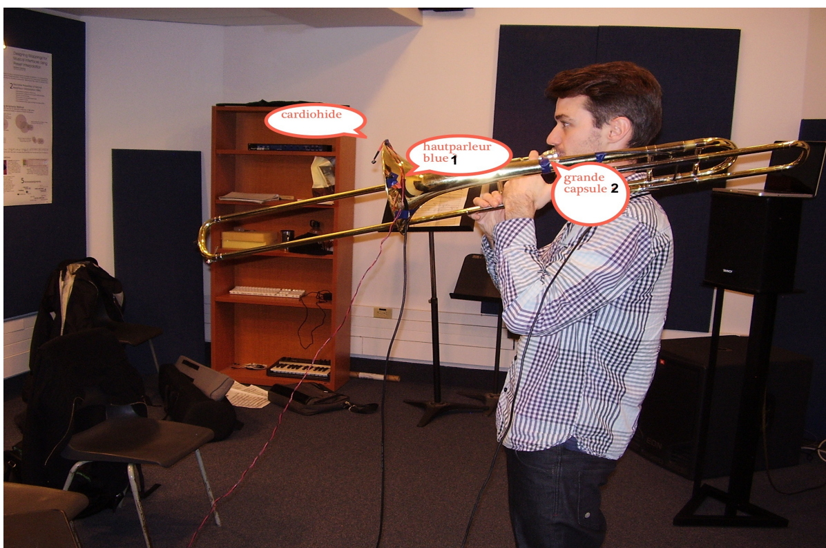
Figure 12 : Système parallèle d'amplification par contact sur le trombone 97
