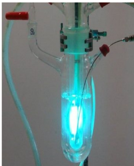
Figure 1-5: Lampe de mercure dans un puits d'immersion
