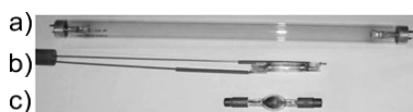
Figure 1-4: Lampe au mercure utilisée pour la photochimie : a) Lampe à basse pression, b) Lampe à moyenne pression, c) Lampe à haute pression
