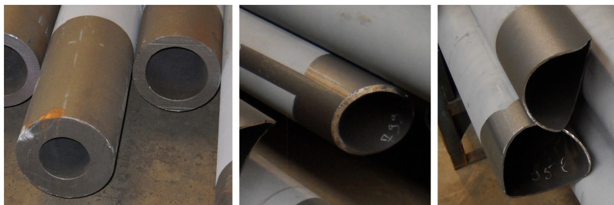
Figure 83 : Jakob+MacFarlane, Les Turbulences, Frac-Centre, Orléans, 2006-2013. Différence d'épaisseur entre les tubes. Visite du site de production d'ERCTM à Épinac, 2 juillet 2010. Source : archives professionnelles de Jakob+MacFarlane
