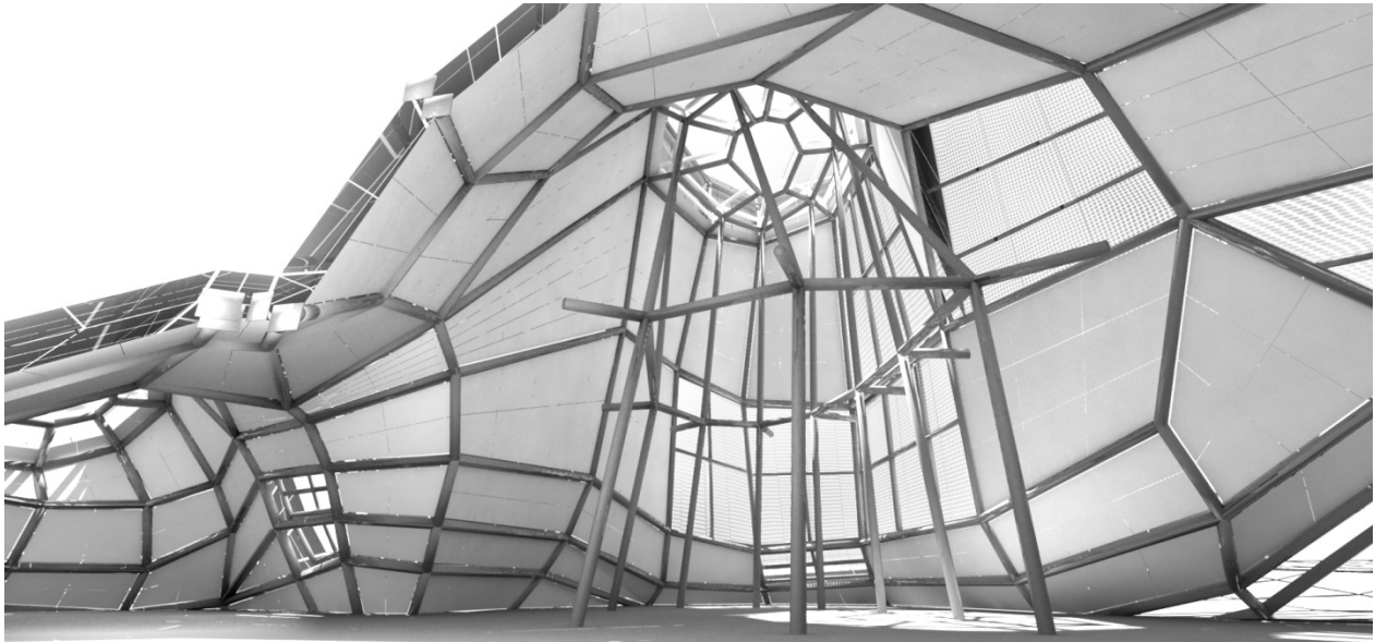
Figure 75 : Jakob+MacFarlane, Les Turbulences, Frac-Centre, Orléans, 2006-2013. Rendu infographique illustrant le principe morphologique de double enveloppe, Image réalisée par les architectes à partir du modèle numérique partagé par l'équipe de maîtrise d'œuvre, 17 septembre 2010. Source : Archives professionnelles de Jakob+MacFarlane.
