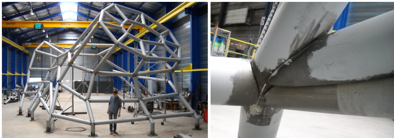
Figure 84 : Jakob+MacFarlane, Les Turbulences, Frac-Centre, Orléans, 2006-2013. Montage à blanc de l’ossature tubulaire de la plus petite excroissance. Visite du site de production d’ERCTM à Épinac, 2 Juillet 2010. Source : archives professionnelles de Jakob+MacFarlane
