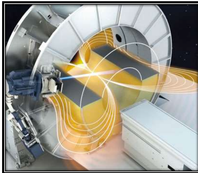
FIGURE 0.4. Le système IRM-linac des compagnies Elekta et Philips créé à Université d'Utrecht aux Pays-Bas [25].
