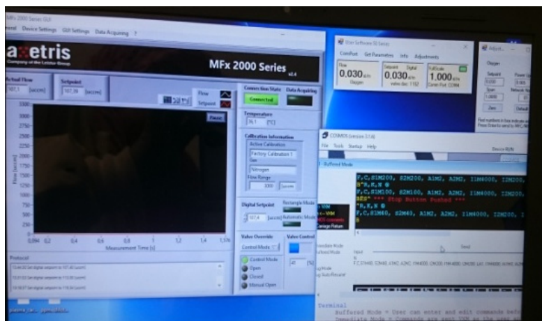
Figure 20. Écran de contrôle des débitmètres et du moteur sur l’ordinateur portable.
