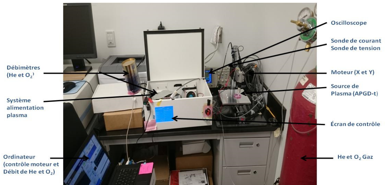
Figure 14. Photo prise en laboratoire du système expérimental permettant de générer un plasma à la PA (APGD-t).
