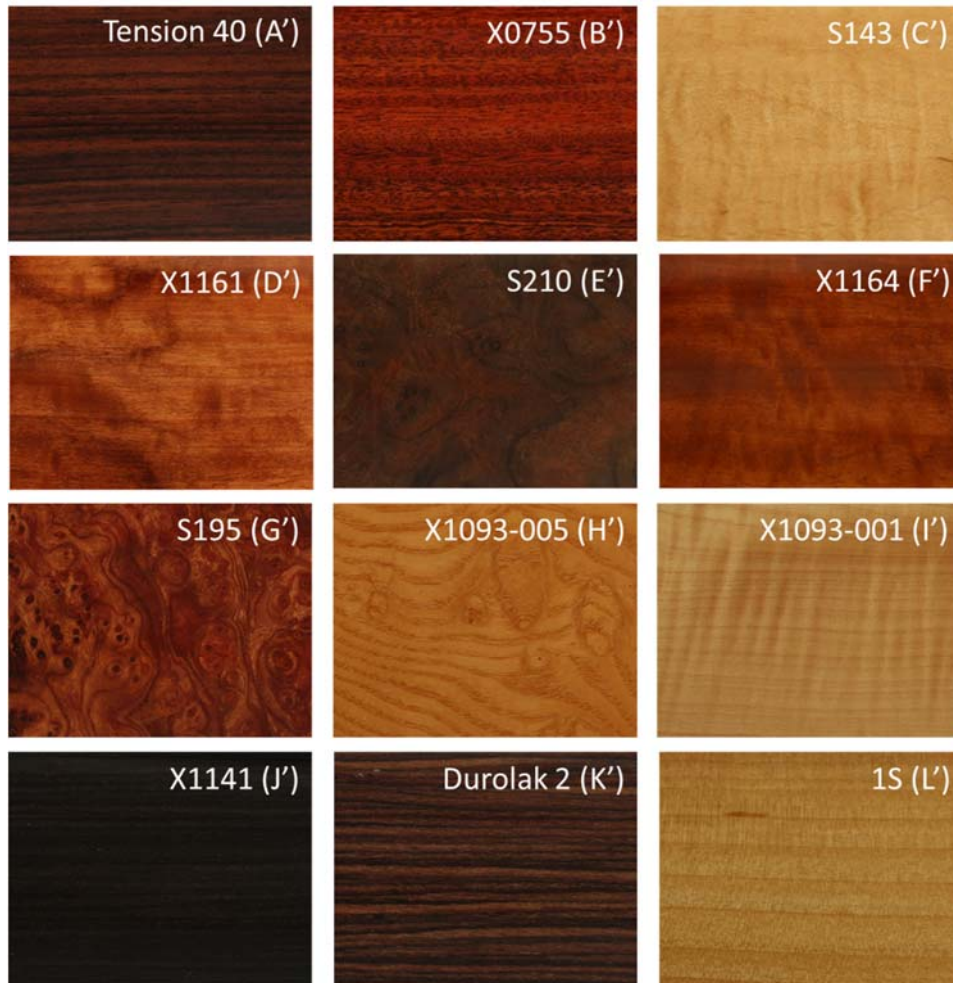
Figure 2.5 : Vue en plongée et classement qualitatif des échantillons Tension 40 (A'), X0755 (B'), S143 (C'), X1161 (D'), S210 (E'), X1164 (F'), S195 (G'), X1093-005 (H'), X1093-001 (I'), X1141 (J'), Durolak 2 (K') et 1S (L'). A' est le meilleur échantillon (peu d'effet peau d'orange), L' est l'échantillon avec l'effet peau d'orange le plus prononcé et les échantillons B'-K' présentent un effet peau d'orange d'autant plus intense que la lettre est proche de la fin de l'alphabet.
